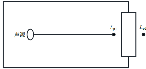
图5.2-17 室内声源等效为室外声源图例
